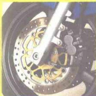
**Baugleiche Scheibenbremsen mit Tokico-Schwimm-sätteln, die auf 300er Bremsscheiben zugreifen.**
